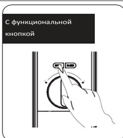
Дважды нажмите функциональную кнопку [Открыть] в течение одной секунды, затем нажмите или потяните, чтобы отпереть дверь.
